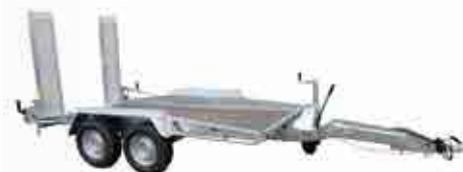
Châssis soudé galvanisé à chaud
